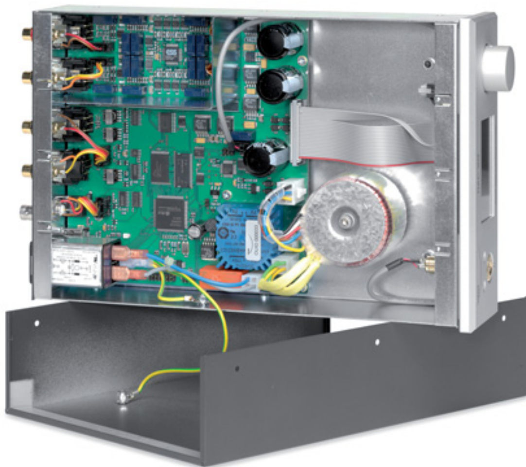
Klein, aber voll mit hochkarätiger Technik. Auffallend: Trafo-Netzteile statt Schaltnetzteil
