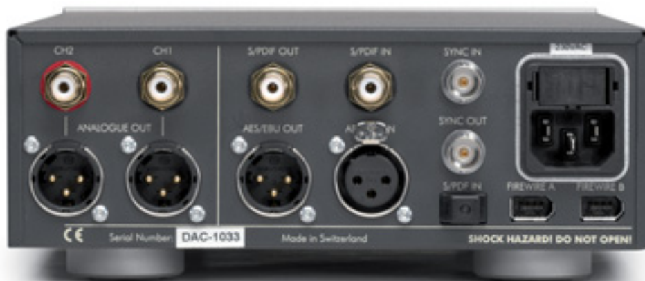
Rechts unten die beiden Firewire-Buchsen. USB ? Nein danke, sagt Daniel Weiss
